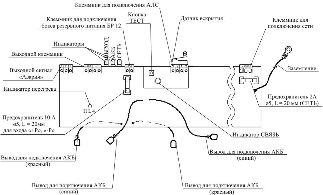
Рисунок 1 – Плата источника
